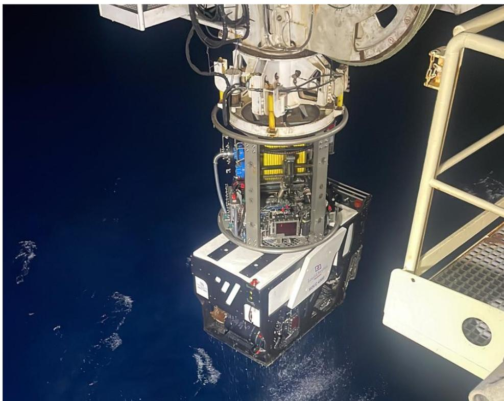
Les ROV-C sont des ROVs de travail compacts offrant une grande maniabilité. Fiables et faciles à entretenir, ils fournissent une puissance de 100 cv et un outillage d'intervention de pointe.
