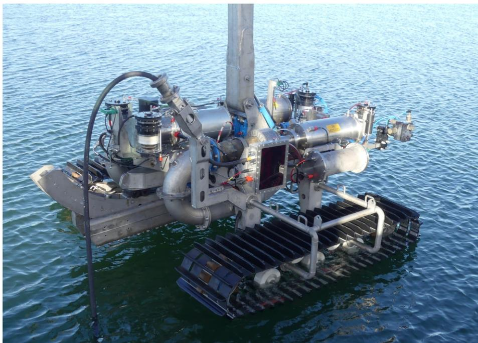
T.O.Mobile NV est un engin léger, adapté aux travaux de post-ensouillage dans des sols jettable.
