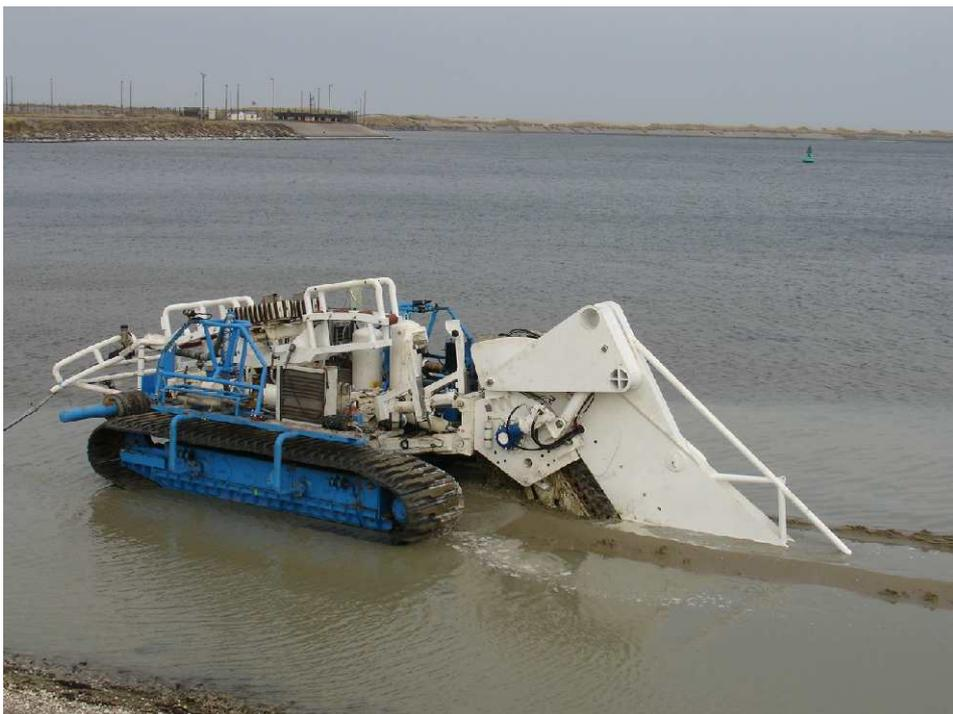
TM 03 est un porteur sur chenilles destiné à l'ensouillage de câbles sous-marins. Conçue et fabriquée par LD TRAVOCEAN, TM03 est une machine opérée depuis la surface, qui selon le type de sol, peut être équipée de différents outils :
