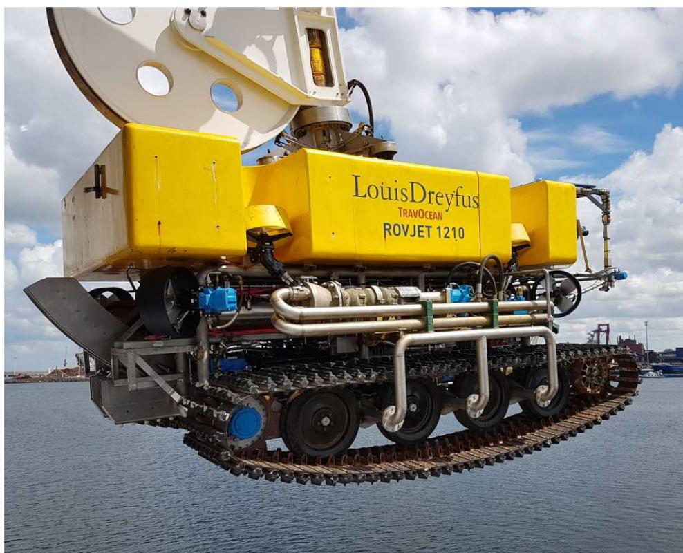
Avec des équipements à la pointe de la technologie, ROVJET est un R.O.V\* équipé de bras de jetting capables d'ensouiller un câble jusqu'à 3,00 m de profondeur.
