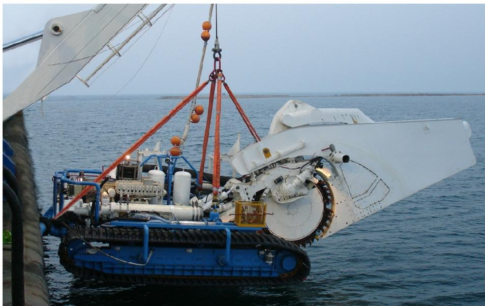
TM 04 est un porteur sur chenilles destiné à l'ensouillage de câbles sous-marins. Conçue et fabriquée par LD TRAVOCEAN, TM04 est une machine opérée depuis la surface, qui selon le type de sol, peut être équipée de différents outils :
