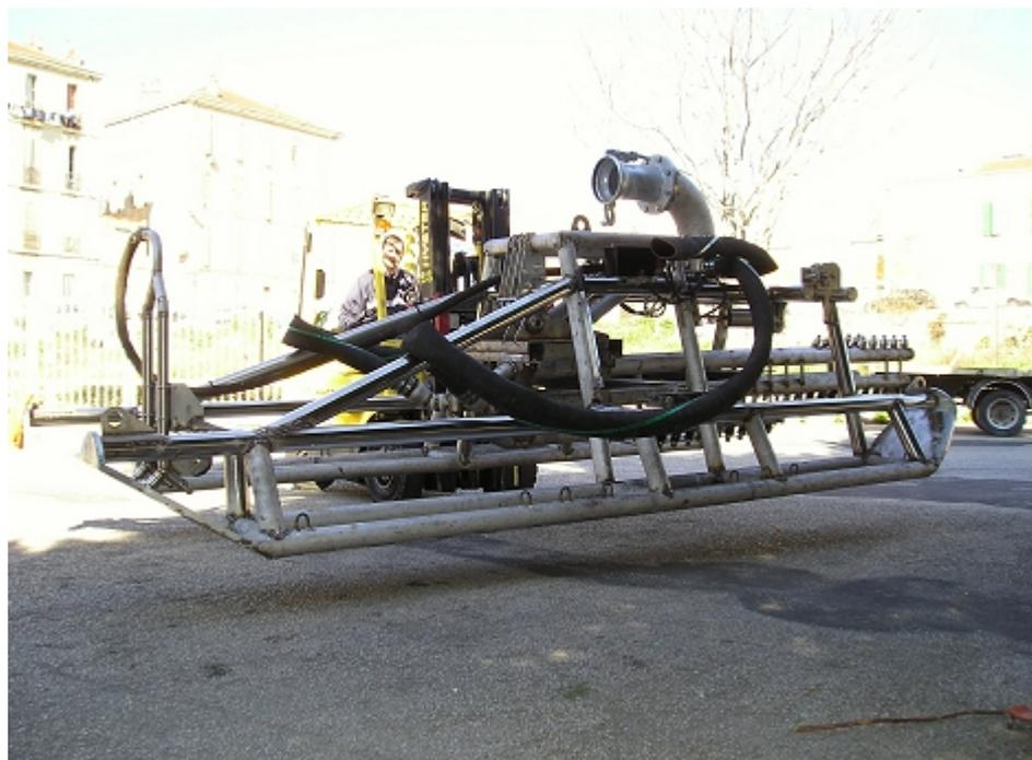
TJV 07 est un traîneau de jetting, adapté aux travaux de post-ensouillage de câbles de puissance ou de fibre optique dans des zones de très faibles profondeurs d'eau.
