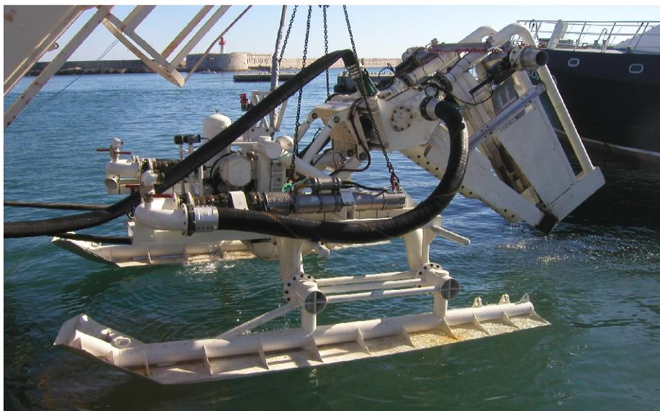
TJV 06 est capable de trancher le sol sous-marin de part et d'autre d'un pipeline.
