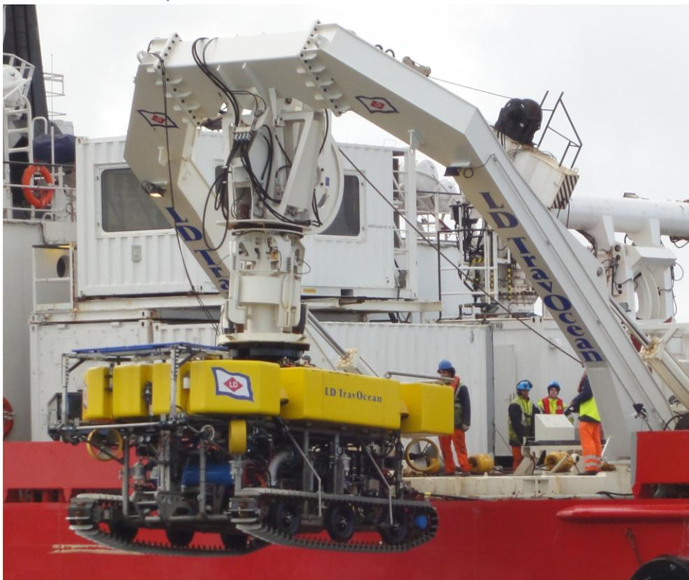
Avec des équipements à la pointe de la technologie, ROVJET est un R.O.V\* équipé de bras de jetting capables d'ensouiller un câble jusqu'à 2,20 m de profondeur.
