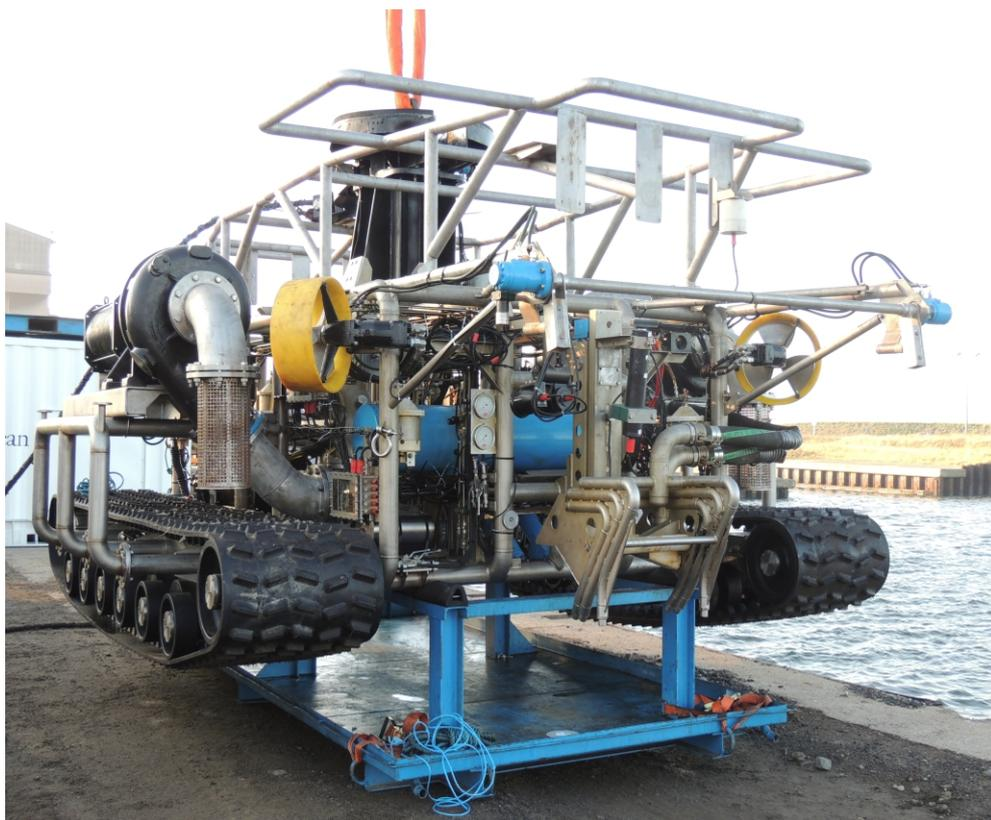
Avec des équipements à la pointe de la technologie, ROVJET est un R.O.V\* équipé de bras de jetting capables d'ensouiller un câble jusqu'à 2,20 m de profondeur.
