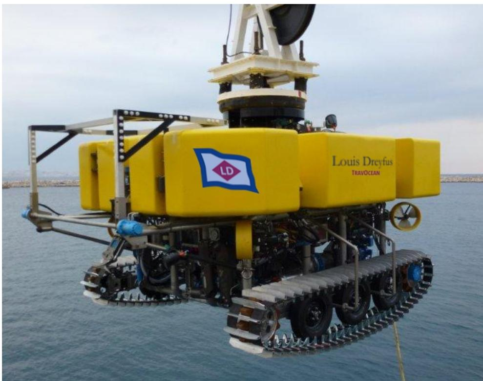
Avec des équipements à la pointe de la technologie, ROVJET est un R.O.V\* équipé de bras de jetting capables d'ensouiller un câble jusqu'à 1,00 m de profondeur.
